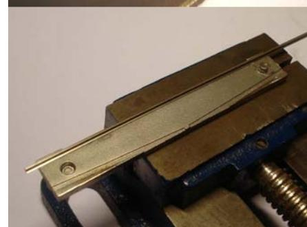
Dans les rainures obliques, comme pour l'outil à deux tangentes, le rail doit porter au fond de la rainure jusqu'en butée médiane.
