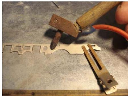
Bien ébavurer les attaches des entretoises 105 à 110 : pour la géométrie des longerons, la largeur doit être respectée.
