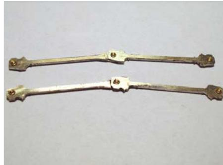
Préparer les bielles motrices 505 à 508 : souder dos à dos, ébavurer, polir, un palier 90004U doit entrer juste du côté du maneton. Ces bielles remplacent celles d'origine dans le sous-assemblage dont voici un éclaté : on voit la crosse, le petit mécanisme et l'autre sous-assemblage qui contient maneton, bielle de coulisse et coulisse.
