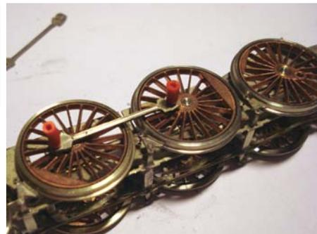
Comme on le voit sur l'image précédente, insérer des sections d'isolant de fil électrique pour arrêter provisoirement les bielles sur les manetons pendant vos essais. Tourner la machine et poser l'autre bielle avant : si les axes sont parallèles, pas de point dur et vous pouvez rouler au doigt. Maneton vers l'avant, un tronçon de fil sur le maneton avant, poser une bielle arrière et faire les mêmes vérifications.
