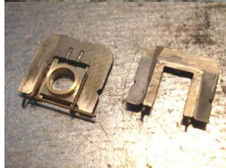
Voici à gauche un palier fixe terminé : c'est le seul montage où le doigt de centrage du ressort est conservé complet, ce qui amène le palier à la hauteur exacte des encoches latérales des glissières.
