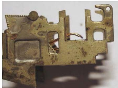
L'essieu du bissel vient monté avec ses deux paliers qu'il n'est pas nécessaire de souder, ce qui le maintient démontable.
