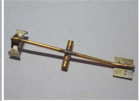
Mettre la poutrelle pivot en place, ainsi qu'un faux essieu muni de ses paliers, qui sera moins encombrant que les roues à ce stade. Glisser le balancier et sa bride le long de la poutrelle pivot jusqu'à ce que les deux touches du balancier soient centrées sur les paliers.
