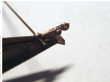
Une encoche pratiquée dans les longerons permet de positionner les sabots de l'essieu avant, en insérant un fil de laiton de 0.4 mm de part en part.
