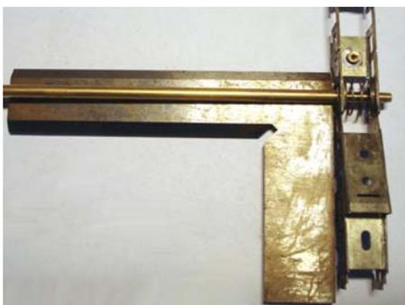
Placer une équerre pour vérifier que l'essieu soit bien perpendiculaire aux longerons, la barre doit être parfaitement horizontale.
