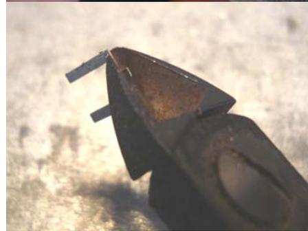
Passer deux fils de laiton à la fois dans les trous de positionnement du guide et de la glissière - diamètre 0.3 ou 0.4 mm selon le diamètre auquel vous les aurez ajustés.
