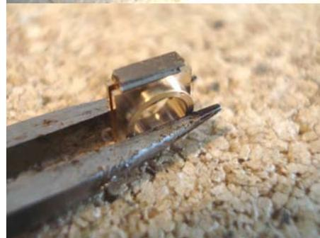
Pour un montage fixe, dégrapper deux cales d'épaisseur et saisir un palier comme indiqué, souder très légèrement pour que la portée du palier reste intacte.
