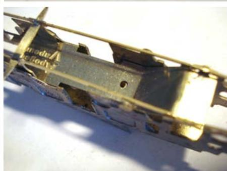
Positionner une tringlerie de freins le long du fond au moyen de pinces à cheveux, souder les deux pattes au centre puis celles des extrémités.
