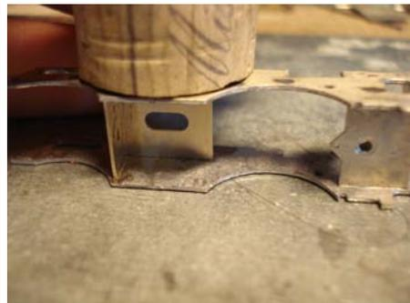
Orienter et insérer entre les longerons l'entretoise 108 avec son écrou soudé, bien l'engager dans les rainures et en appuyant avec un bouchon, souder en place.
