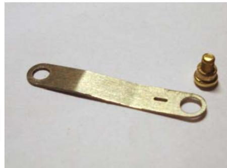
Voici la barre de liaison montée sur le bogie, l'entretoise est serrée par la vis qui immobilise la retenue (et les essieux plus tard) et la barre est guidée en rotation.
