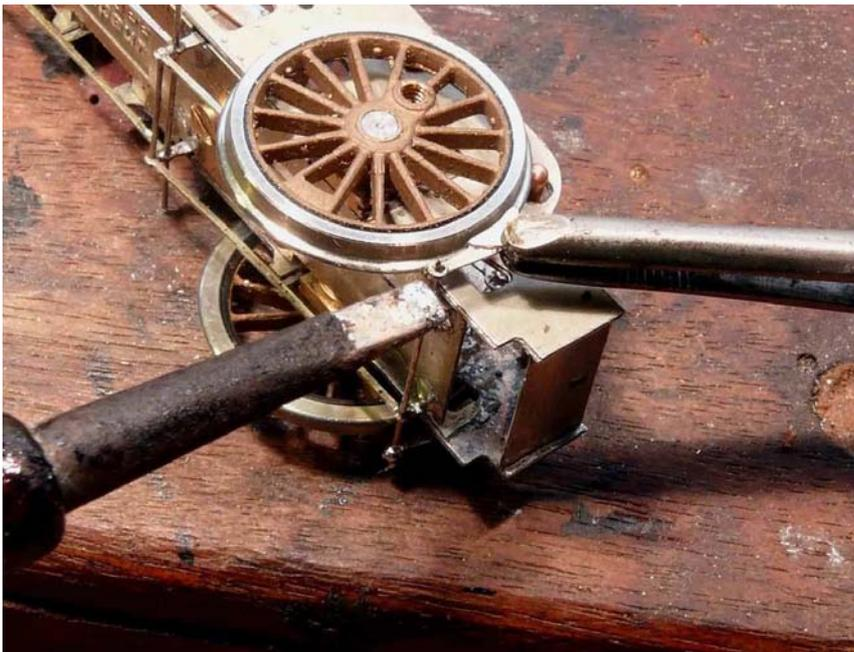
Une fois tous les sabots, en place vérifier en faisant bouger les roues radialement et axialement que les sabots de frottent pas.
