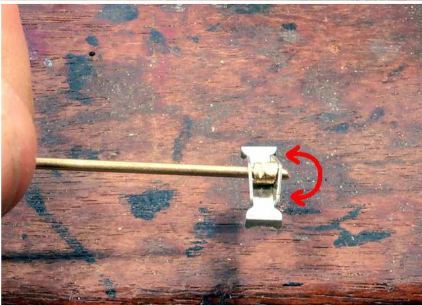
On positionne ensuite le balancier exactement à l'aplomb des paliers du 2ème essieu.
