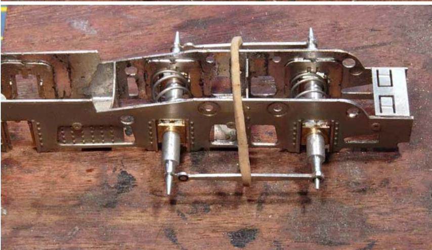
La planche des glissières en fournit plus que nécessaire, et j'en ai préparé une qui me sert de référence pour l'ajuster aux paliers déjà montés sur les essieux.
