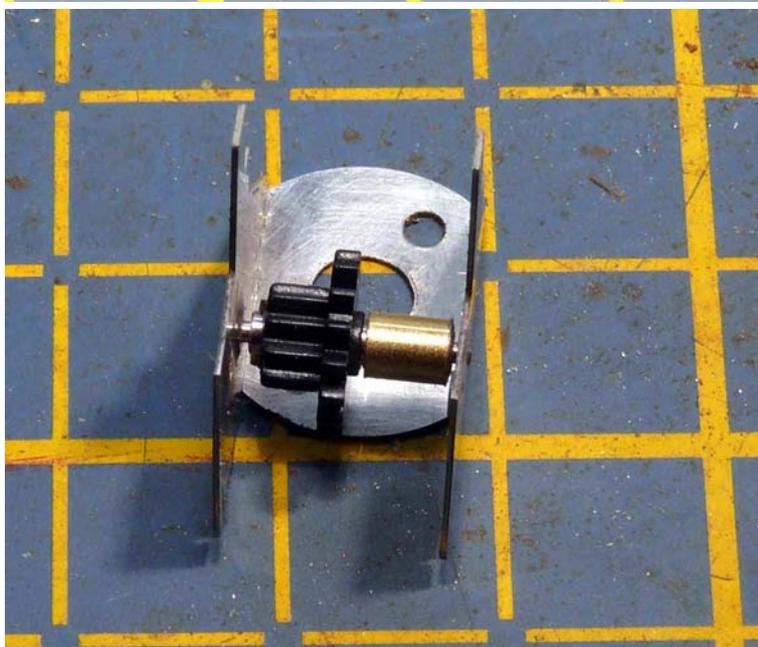
On introduit ensuite l'étage secondaire en positionnant bien le train d'engrenage comme sur la photo, c'est à dire entre le flanc du réducteur et la roue de l'étage primaire.
