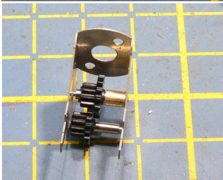
Insérer l'entretoise inférieure avec un écrou et souder le tout par en-dessous.
