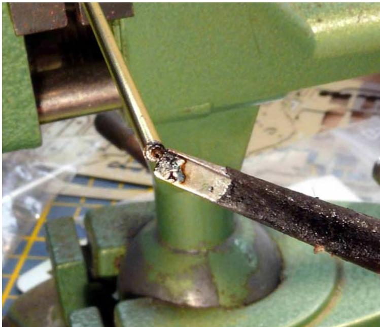
Dans une boîte à onglet, on coupe un tronçon de 3,5 mm de long. On répète l'opération 3 fois et on a des arrêts de palier permettant de bloquer l'ensemble des essieux au fond de leur logement.
