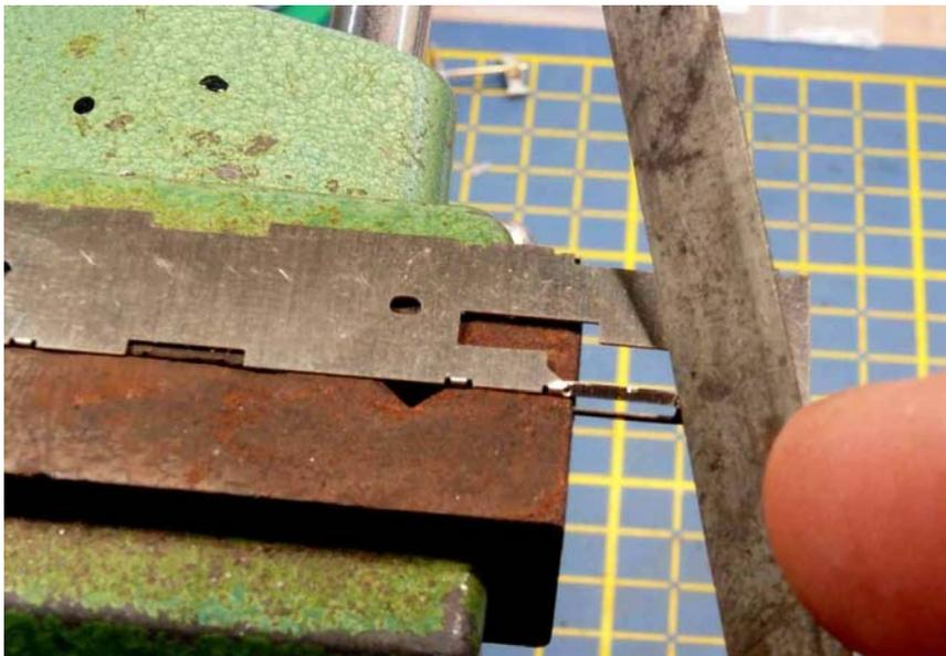
On relie à l'aide d'un fil de 4/10° les pivots de frein que l'on recoupe au ras, puis on soude les barres de 4/10° qui supporteront les sabots de frein. Il faut les laisser généreusement dépasser de chaque côté pour ne pas être trop court au moment de la soudure des sabots.
