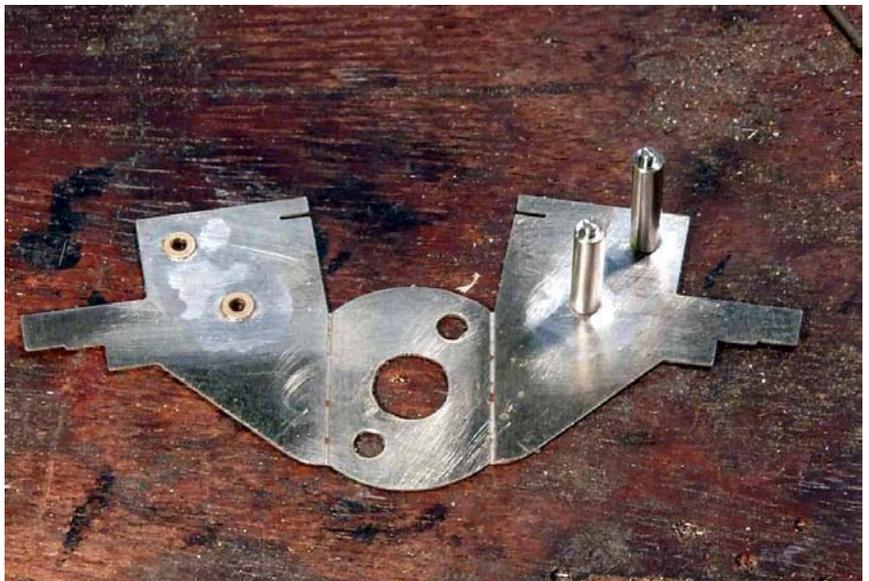
Replier les flancs du réducteur en suivant parfaitement la rainure de pliage.
