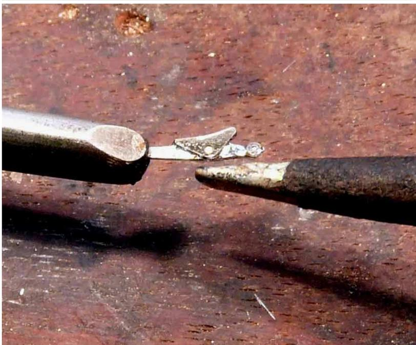
Bien agrandir le trou à l'aide d'une lime aiguille. Éventuellement, le repercer avec un forêt de 4/10° s'il a été malencontreusement bouché au moment de la soudure.
