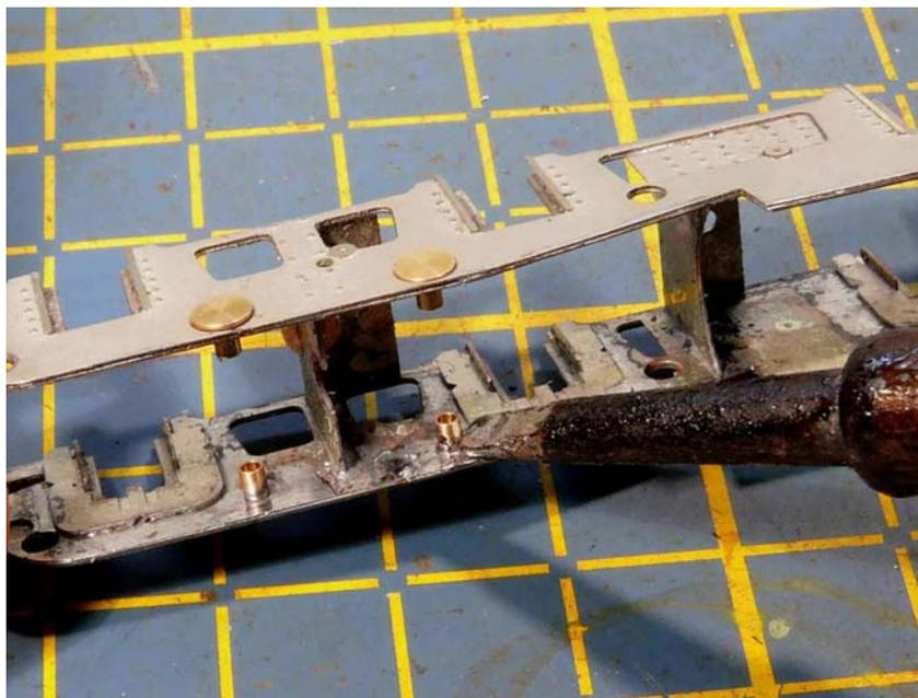
Les 2 bagues isolantes doivent entrer dans les 2 trous du centre des supports de palpeurs. Malheureusement ceux-ci sont d'un diamètre beaucoup trop petit. Repercer à l'aide d'une mèche de 2mm.
